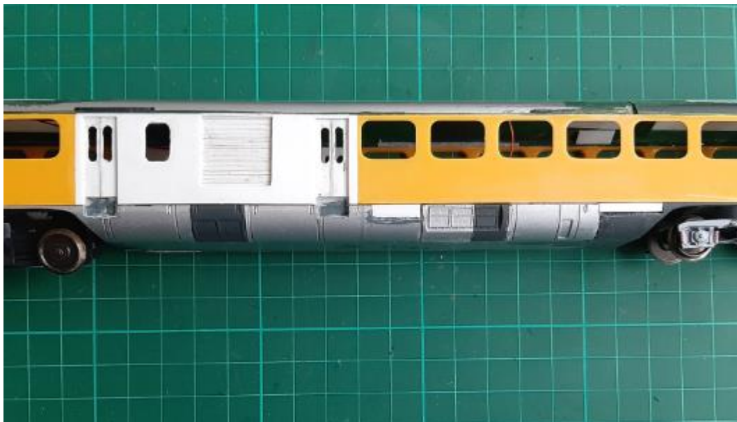
Rechterzijde, met kap erop: links en rechts de drie nieuwe koelroosters en ook hier dichtgemaakte en nieuwe smalle gaten voor de treeplanken...
